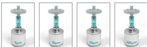
Selon la précision et la limite de détection des tailles de fuite choisies, tous les appareils d'analyse TPC-II sont ajustés avec des fuites de test calibrées.
